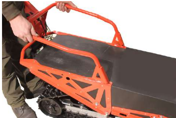
27. Снимаем багажник, потянув на себя и вверх
