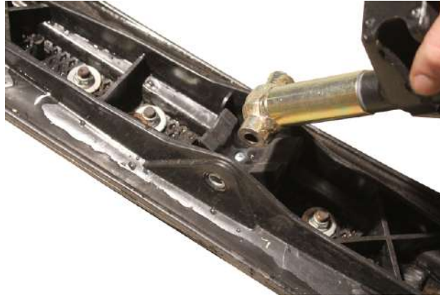
27. Снимаем багажник, потянув на себя и вверх
